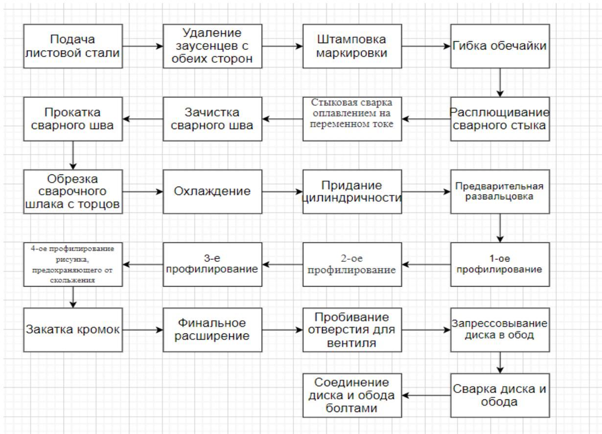
Рисунок 3 – Схема декомпозиции технологического процесса
